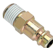
77NMC2 88104070 Priključki vrste IBN/IBS, 1/4" moški navoj, 7,2 mm vrtina (EURO 7,2 - 7,4)
